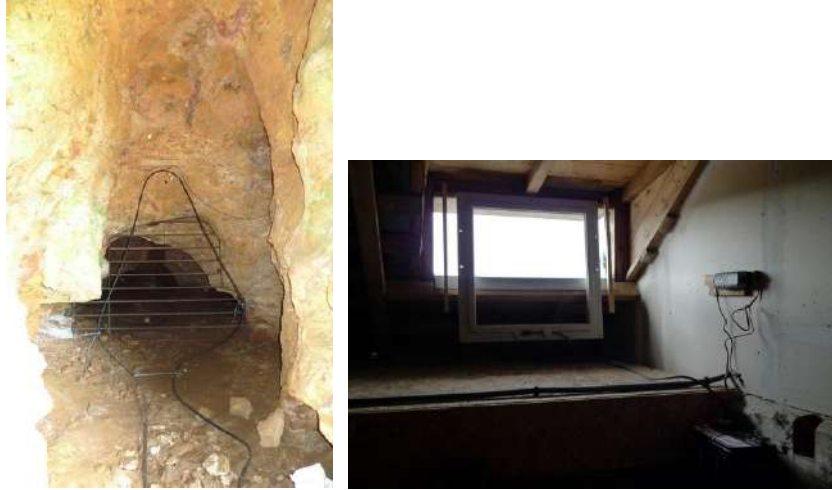
Figure 4 : « Antenne corde » installée à Melle (79) à gauche et « antenne-cadre » installé à Annepont (17) (M. LEUCHTMANN)
